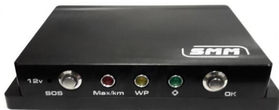
Кронштейн должен быть установлен на передней части квадроцикла (ATV). Индикаторы должны быть видны водителю (ATV) и штурману (SSV). Кнопка SOS должна быть легкодоступна водителю (ATV) и штурману (SSV) для ее нажатия в случае необходимости
