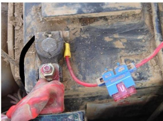
Подсоединить красный провод к + 12v (красная клемма), а черный провод к минусовой клемме аккумулятора.
